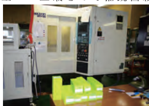
自動運転中のメクトロン「MCH-80」。手前にはスーパーG1チャックのケースが並ぶ
