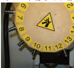
ロボドリルにセットされた「スーパーG1チャック」群
