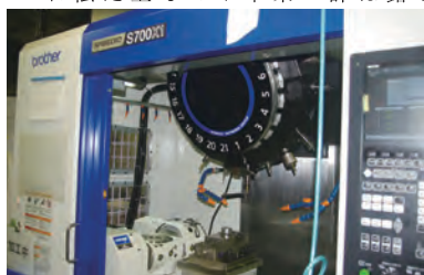
スーパー G1 チャックをセットした新規設備はインデックテーブルもユキワ精工製
