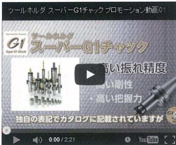
ツールホルダメーカー各社は、振れ精度を独自の表記でカタログに記載していますが、重要なのは実機上での振れ精度。「スーパーG1チャック」は、総合振れ精度表記で振れ精度を保証しているので、実機上でもカタログ値通りの高い振れ精度を実現する。高い振れ精度のツールホルダを使用することで、1本の工具での加工個数の増加が十分に期待でき、工具交換回数も減り、加工費の削減に大きく寄与する。
