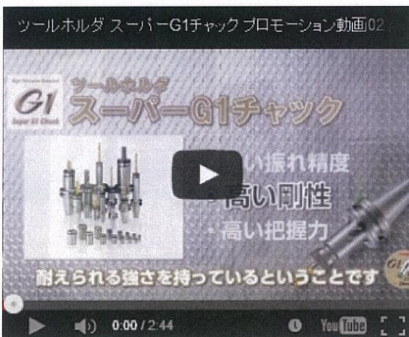
一般的なミーリングチャックは、把握力は高いが剛性が低いため、横方向に倒れが発生し高い加工音が発生する。「スーパーG1チャック」は、高い剛性を持ち合わせているので、横方向に加工負荷が掛かってもホルダの倒れが少なく、加工音が非常に静か。ツールホルダの剛性はワークの面粗度にも大きく差が
