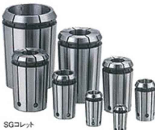
の方式を採用することにより、ホルダ本体の口元の肉厚を厚くし、ナット締め付け時の変形を抑えられる。その結果、芯のズレを最小にすことができる。“総合芯振れ精度3μm保証”という精度を確保している。
